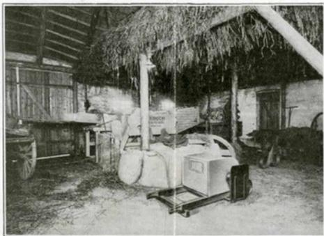
Fig. 4. — Moteur transportable renfermé dans une caisse blindée, étanche, incombustible et ignifuge. Machine à battre du type intérieur avec compresseur de paille.
